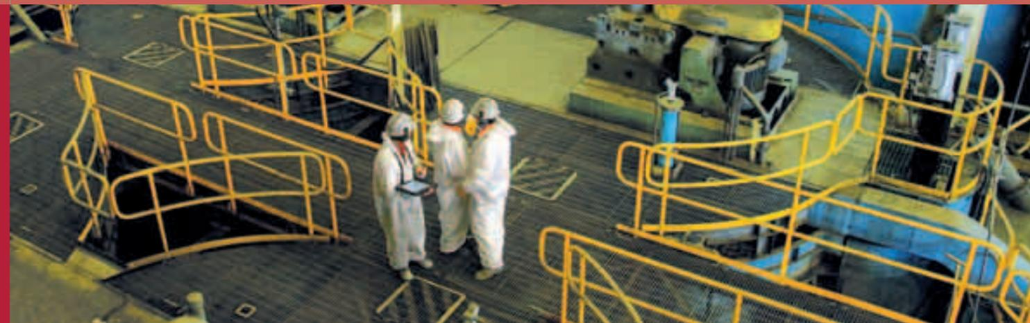
Operadores controlan el nivel de aire de las celdas durante el proceso de flotación
