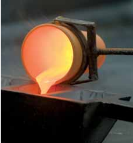
Vertido de oro fundido en cubeteras para producir oro doré.
