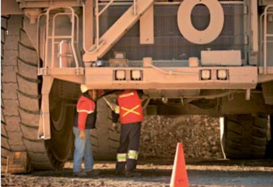
1 Tareas de reparación de un camión CAT 793 en el Taller de Mantenimiento Mecánico.
