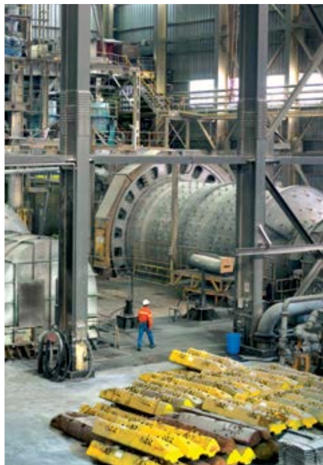
Vista de la Planta Concentradora, donde se realiza la trituración y molienda de la roca extraída.
