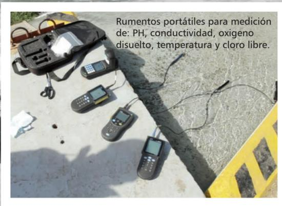
Rumultos portátiles para medición de: PH, conductividad, oxígeno disuelto, temperatura y cloro libre.
