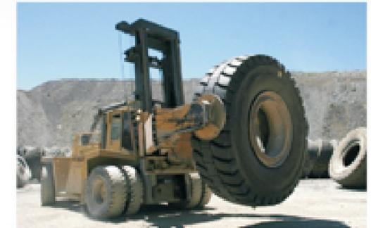
El gato hidráulico con el que se levantan los camiones de 154 toneladas tiene 150 toneladas. Hay máquinas especiales que sacan las tuercas y bulones de las ruedas. Y para retirar los neumáticos hay un auto elevador, que hace el movimiento de dos brazos humanos.
